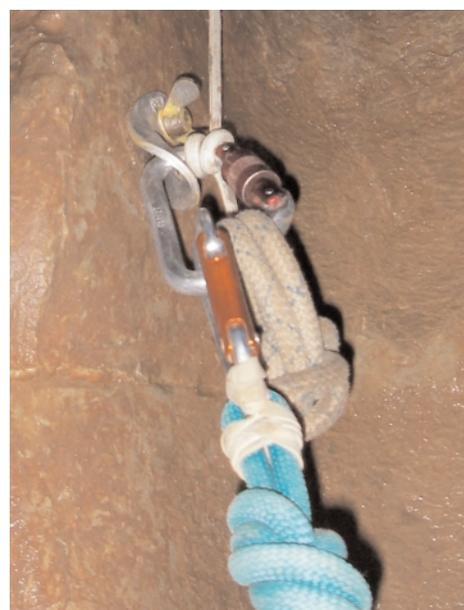
L'amarrage est doublé grâce à un long bout de dyneema qui va permettre d'utiliser une concrétion bien au-dessus. Cette technique permet d'éviter les frottements de la corde, d'économiser celle-ci tout en doublant l'amarrage.
