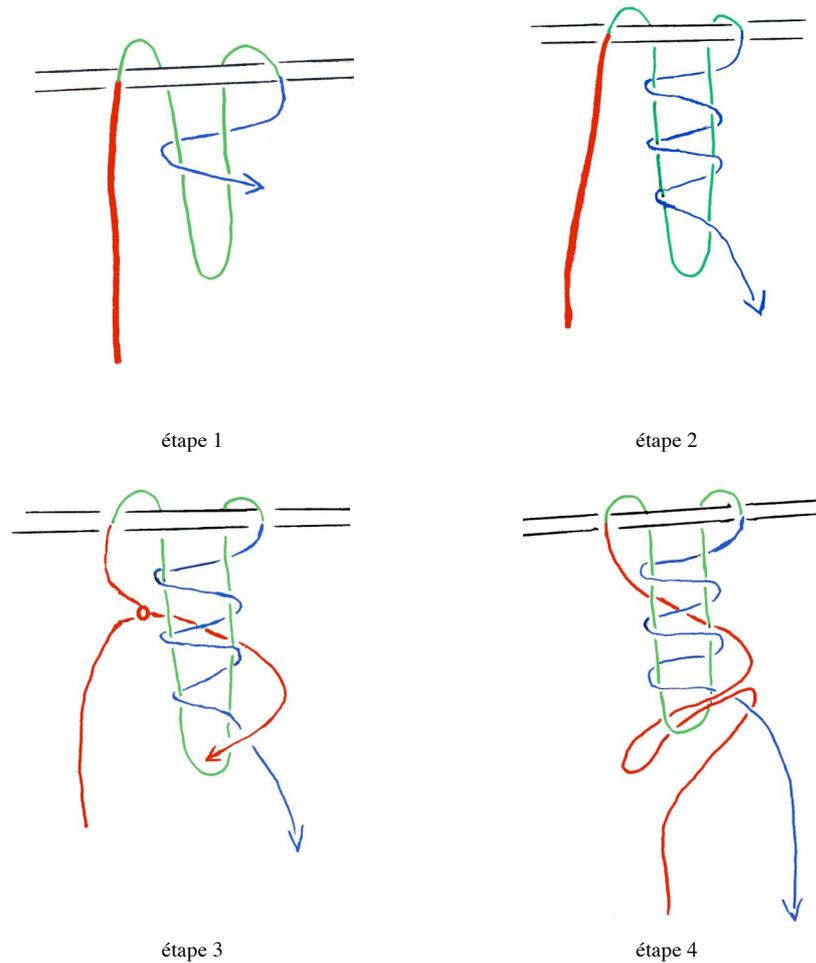
Figure 2 : réalisation du Nœud en Tire-Bouchon
