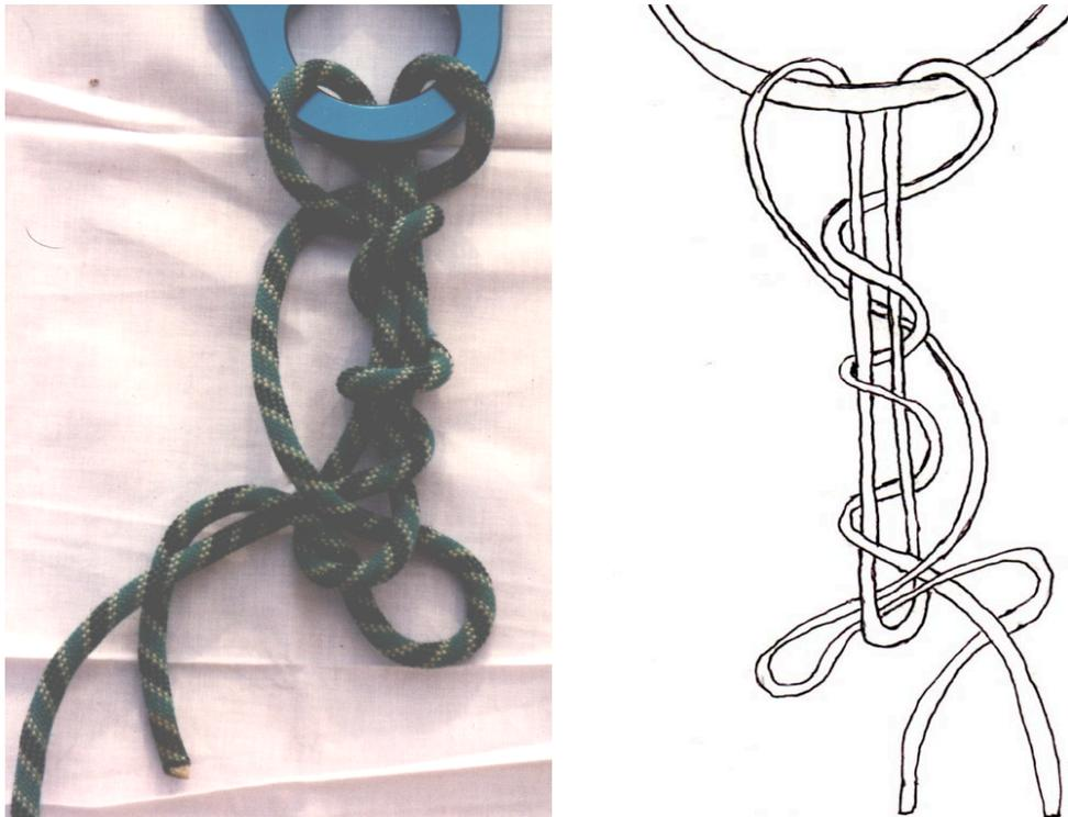
Figure 1 : le Nœud en Tire-Bouchon ou NTB
