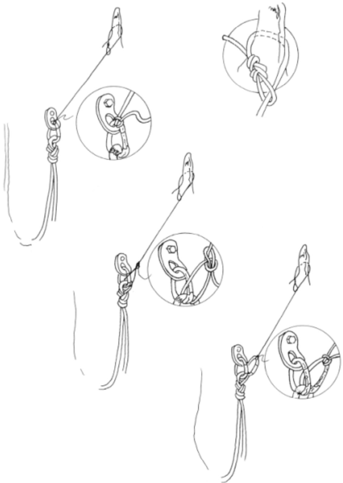
Figure 8 □ Différentes techniques de doublement de fractionnement
